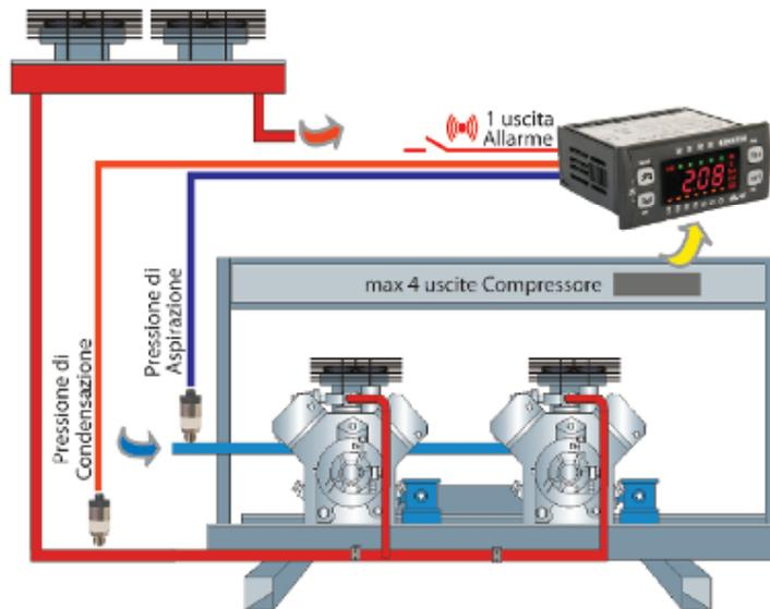
Может использоваться для управления температурой в режимах Нагрев или Охлаждение или регулирования давления его повышением или снижением
