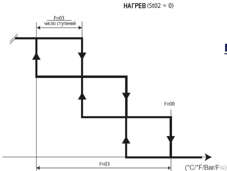
Пример показывает случай с боковым размещением Рабочей точки (St01=1). При центральном размещении Рабочей точки (St01=0) пропорциональная зона делится пополам Рабочей точкой или Рабочая точка находится в середине пропорционально зоны.
