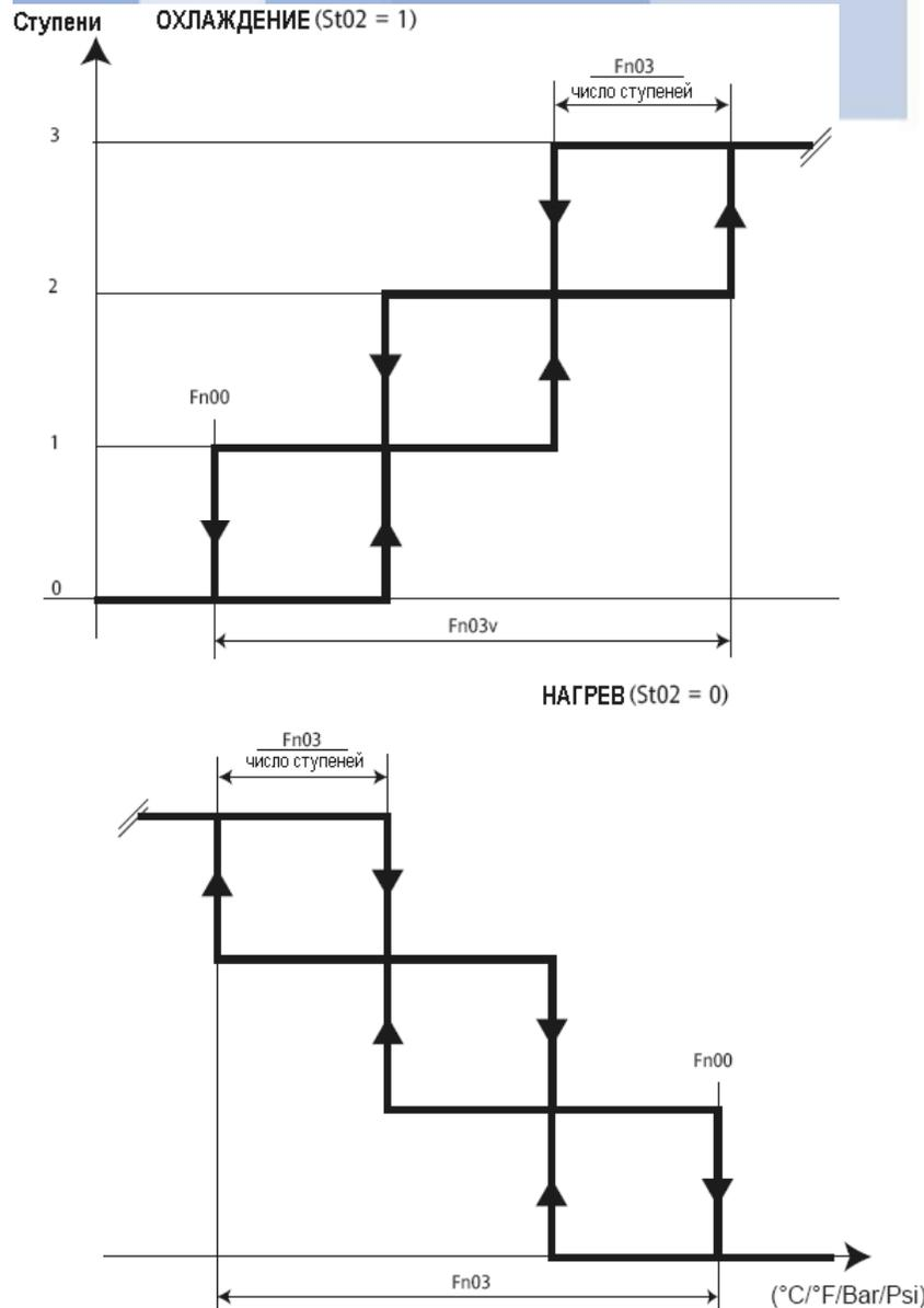
Вентиляторы управляются ступенчато как функция значения с датчика нагнетания.
