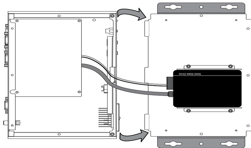
Снимите крышку, уделяя внимание целостности кабелей подключения SSD или HDD диска.
