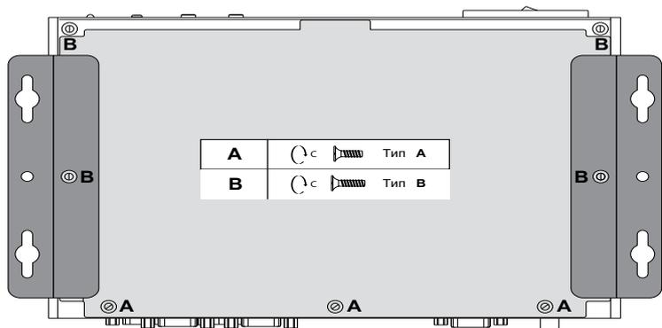
Вывинтите винты крепления крышки. ПОМНИТЕ: используются 2 разных типа винтов (Тип А и Тип В).
