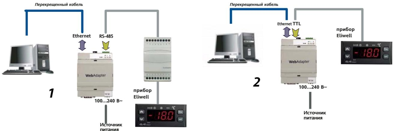
① **соединение по шине RS-485:** используются порты RS-485 на WebAdapter-е и подключаемом приборе. Для приборов, у которых нет встроенного RS-485 можно использовать BusAdapter.
