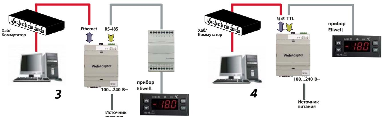
③ **соединение по шине RS-485:** используются порты RS-485 на WebAdapter-е и подключаемом приборе. Для приборов, у которых нет встроенного RS-485 можно использовать BusAdapter.
