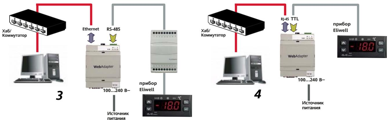
⑦ **соединение по шине RS-485:** используются порты RS-485 на WebAdapter-е и подключаемом приборе. Для приборов, у которых нет встроенного RS-485 можно использовать BusAdapter.
