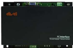
PC Interface серии 2150 это интерфейсный модуль шин RS-232/TTL-RS-485, который позволяет подключить ПК с портом RS-232 (COM) к приборам, совместимым с протоколом Micronet/Televiz (или MODBUS для некоторых моделей) через порт TTL или RS-485. В интерфейсный модуль необходимо установить ключ активизации (BlueCard), который входит в состав комплекта программного продукта Eliwell.
