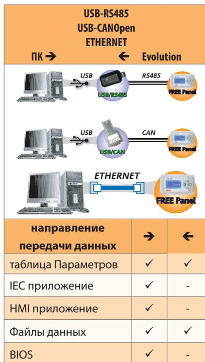
Помните: для подключения через ETHERNET НЕ требуется дополнительных устройств.
