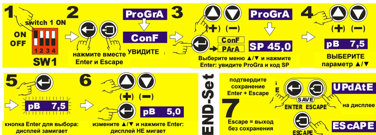
После процедуры регулятор начинает работу с новыми параметрами и отображает значение входного сигнала
