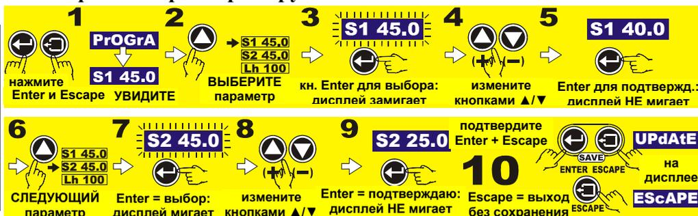
После процедуры регулятор начинает работу с новыми параметрами и отображает значение входного сигнала
