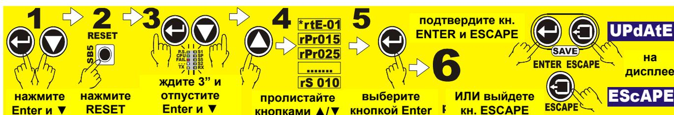
После процедуры регулятор начинает работу с новыми параметрами и отображает значение входного сигнала
