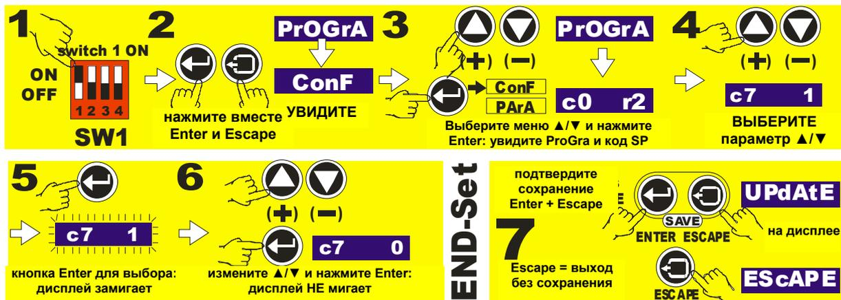
После процедуры регулятор начинает работу с новыми параметрами и отображает значение входного сигнала
