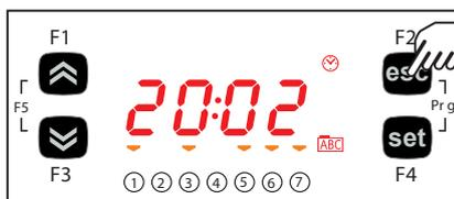
При отображении метки часов **HOuR** Вы кнопками **Вверх** и **Вниз** можете перейти на метки даты **dAtE** и года **YEAr**.
