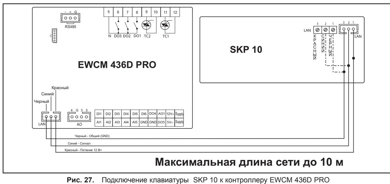
Рис. 27. Подключение клавиатуры SKP 10 к контроллеру EWCM 436D PRO
