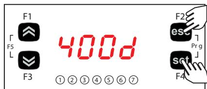
Для открытия меню Программирования BIOS нужно из режима основного дисплея нажать одновременно кнопки **esc** и **set**.
