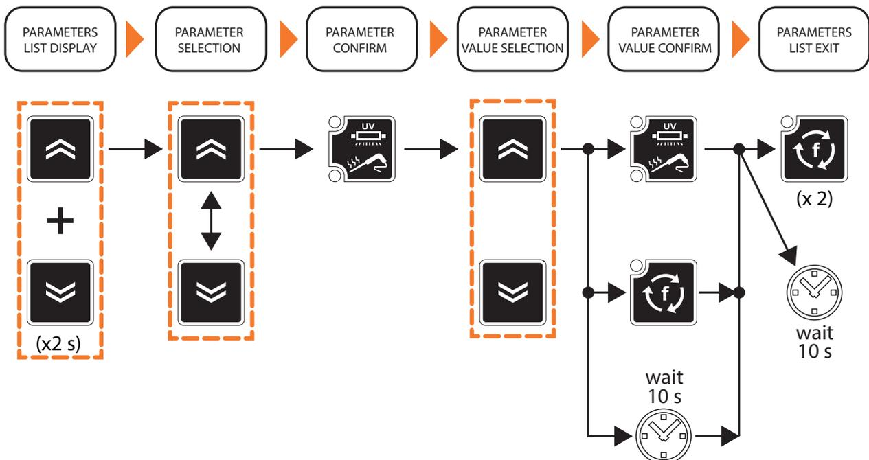
Fig. 24. Parameters configuration
