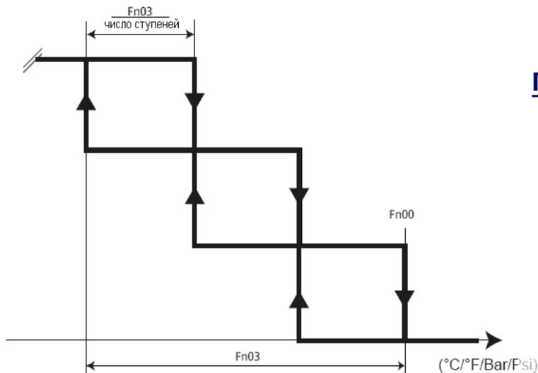
Пример показывает случай с боковым размещением Рабочей точки (St01=1). При центральном размещении Рабочей точки (St01=0) пропорциональная зона делится пополам Рабочей точкой или Рабочая точка находится в середине пропорционально зоны.
