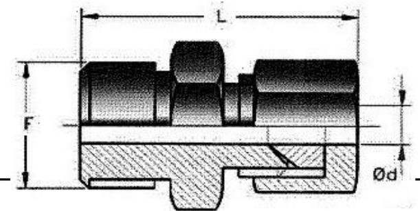
Адаптер для размещения датчиков температуры в газовых средах с небольшим перепадом давления
