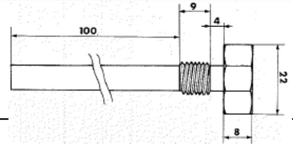
Адаптер для внутреннего размещения датчиков при измерении температуры в жидкостных и газовых средах под давлением
