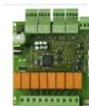
**Контроллеры серии ECH400 (открытая плата, до 4-х компрессоров и до 2-х контуров)**
