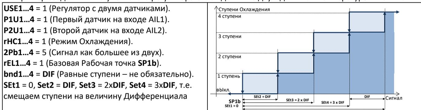
Если задать **OSP1 = 3xDIF, OSP2 = DIF, OSP3 = -DIF, OSP4 = -3xDIF**, то при включение режима Экономии (общего для этих ступеней) произойдет перестановка ступеней 1 и 4 и ступеней 2 и 3, обеспечивая равномерность их загрузки поочередным вводом и снятием режима Экономии.
