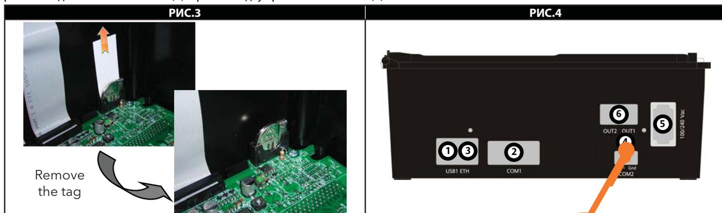
**ВАЖНО:** Уделите особое внимание соблюдению полярности подключения (положительный/+, отрицательный/- и общий/GND) шины RS485 к блоку. (сверьтесь с обозначениями)
