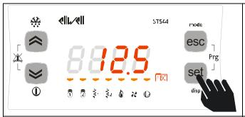
После достижения желаемого значения нажмите кнопку [set]. Прибор запомнит значение 12,5°C.
