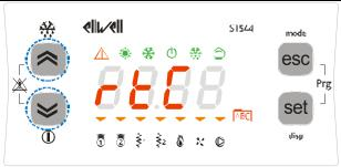
Для изменения индикации дисплея нажимайте кнопки "Вверх" и "Вниз" пролистывая значения до нужного, и затем нажмите кнопку [set] для подтверждения выбора.
