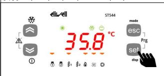
Пример просмотра и сброса времени наработки (часы х1о) для насоса 2
