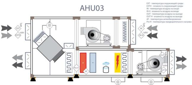
Приложение предназначено для контроля как температуры так и относительной влажности окружающего воздуха с обеспечением максимальной эффективности установки благодаря использованию таких энергосберегающих технологий как возврат тепла и свободное охлаждение.
