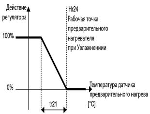
При Осушении элемент НАГРЕВА управляется по датчику температуры предварительного нагрева: Рабочая точка при этом равна параметру <u>Hr24 — Рабочая точка предварительного нагрева при увлажнении.</u>
