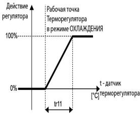
Действие регулятора пропорционально рассогласованию датчика и рабочей точки и достигает насыщения (100%) когда температура с датчика выше рабочей точки ОХЛАЖДЕНИЯ (**T set COOL**) на значение параметра <u>tr11 — пропорциональная зона в режиме Охлаждения</u>.
