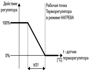
Если после запуска Установки элемент НАГРЕВА будет оставаться на максимальной мощности по истечении времени, заданного параметром <u>tr24- задержка пост-нагревателя</u> при запуске [мин] то активизируются элементы пост-нагревателя для интегрирования их в систему Нагрева.
