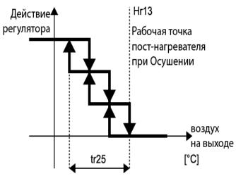
Разрешение работы Осушителя зависит от значения датчика терморегулятора, т.е. если температура ниже чем (**Рабочая точка** — **Hr14**) то Осушитель блокируется и остается заблокированным до повышения температуры до уровня (**Рабочая точка** — **Hr14/2**), где <u>Hr14- температурный дифференциал блокирования Осушения</u>.
