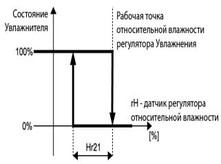
При увлажнении производится так же контроль влажности воздуха на выходе с возможностью блокирования увлажнителя, которое происходит когда значение относительной влажности с датчика на выходе становится выше верхнего предела, задаваемого параметром <u>Hr22 — верхний предел относительной влажности.</u>
