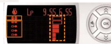
← рисунок С Цифровое управление Вентиляторами
